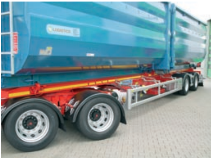
HUFFERMANN 4-akselinen (38T) perävaunu ja lavakokonaisuus kierrätysmetalli-ajoon. Power-Box lavat Hardox 450, 2v takuulla.
