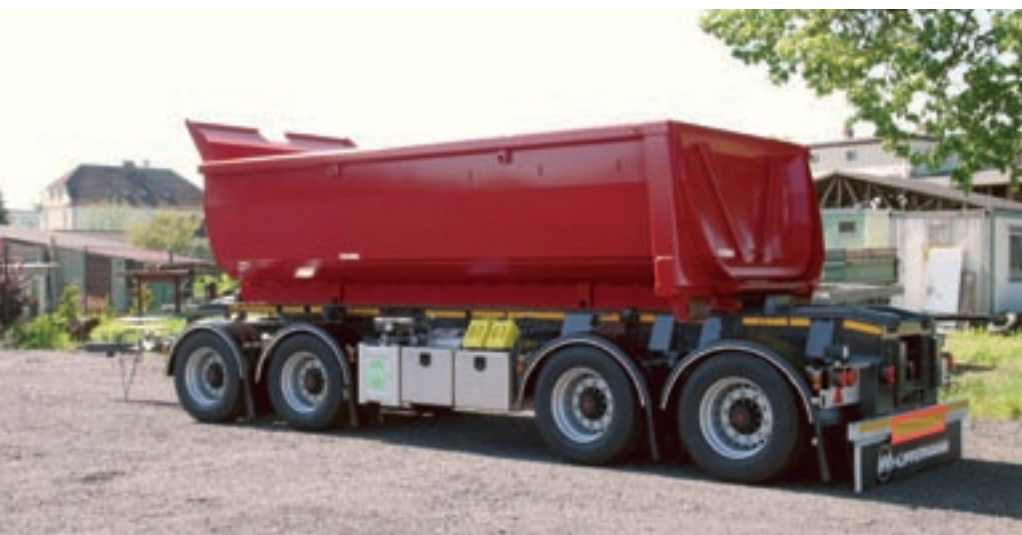
Vaihtolavaperävaunu 36 tonnin kokonaispainoille ja Hardox-lava kovaan käyttöön.
