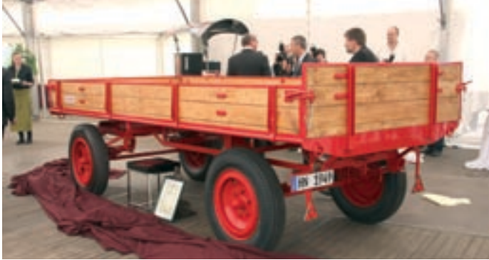
Wilhelm Huffermannin v 1949 valmistama perävaunu, omapaino 1050 kg ja hyötykuorma 3000 kg.
