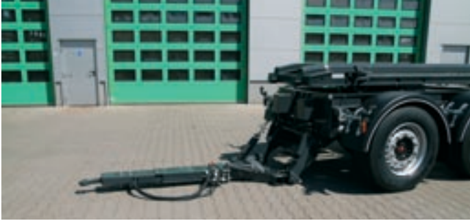
Das Original- Huffermannin varmatoiminen aisamekanismi, D-arvo 190 kN:iin asti.
